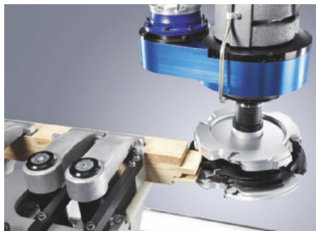
/ Der Weinig-Zangentisch ermöglicht die Komplettbearbeitung der Werkstücke in einer Aufspannung.
