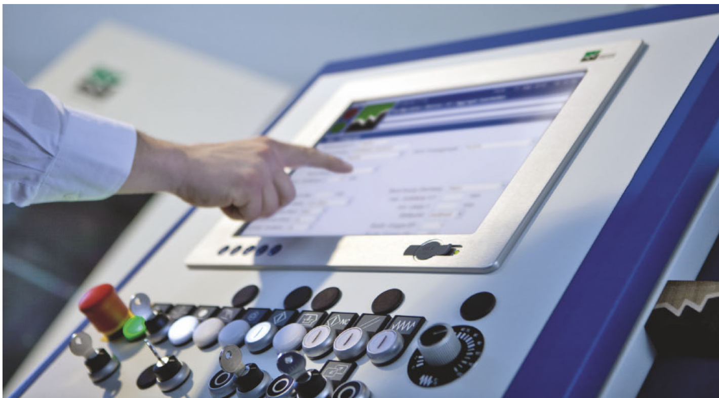
/ Der Leitrechner ist das Herzstück der komplexen Anlage und Kommandozentrale für weit mehr als 100 Achsen.
