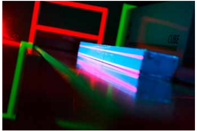
Moulder Preview: Der Laser visualisiert die eingegebenen Werte
