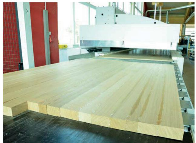
In nur wenigen Minuten sind die Massivholzplatten beleimt, verpresst und fertig ausgehärtet
