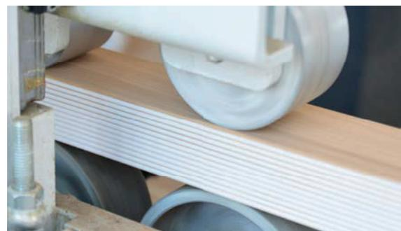
Der automatische Klebstoffauftrag sorgt für exakte, gleichmäßige Dosierung
